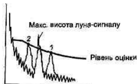
Рисунок В.1 — Спосіб фіксування рівня амплітуди з використанням осі ультразвукового променя
