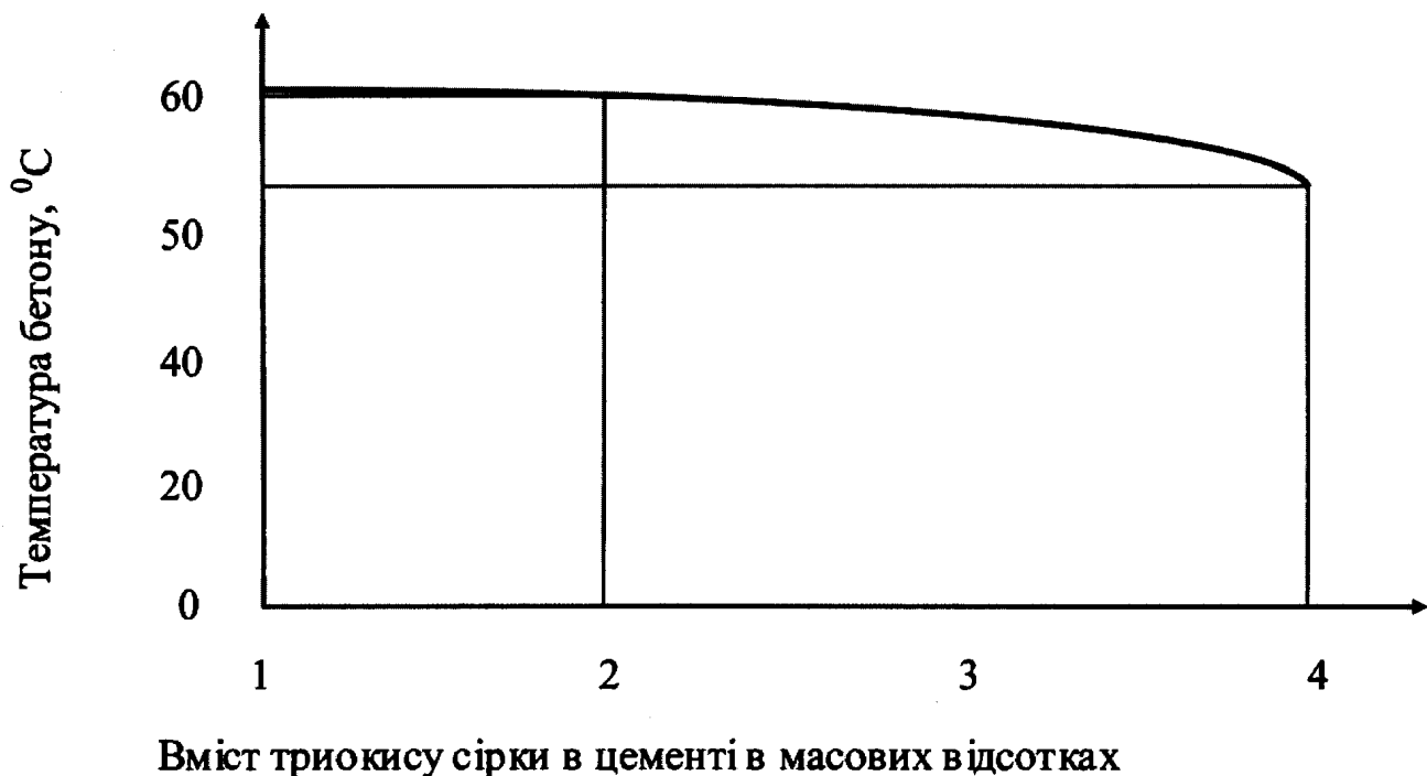
Рисунок 7.5 – Максимальна температура ізотермічного витримування бетону як функція вмісту триоксиду сірки в бетоні
