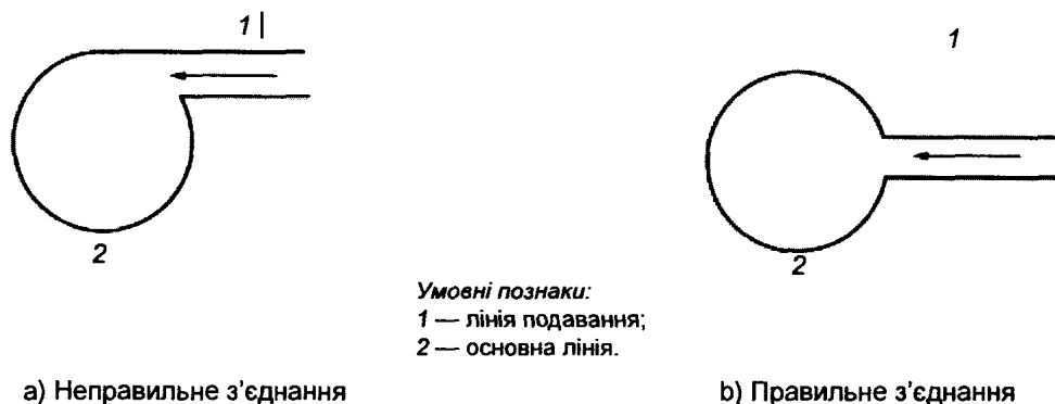
Рисунок 1 — Під'єднання лінії подавання води до основної лінії
